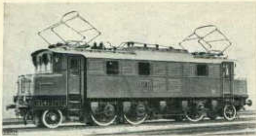
Abb. 7. 1 Co 1-Schnellzuglokomotive Reihe E 04 der Deutschen Reichsbahn- Gesellschaft mit Federtopf-Antrieb.
