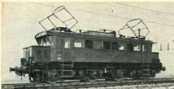
Abb. 14. B 0 -B 0 -Personenzuglokomotive Reihe E 44 der Deutschen Reichsbahn-Gesellschaft mit Antrieb durch Tatzenlagermotoren.
