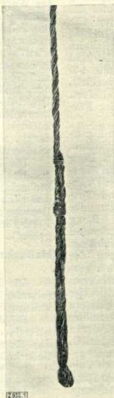
Abb. 1. Albertsches Drahtseil aus der Einführungszeit (Einbandende).
