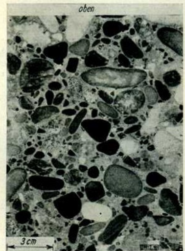
Abb. 10. Versuchsmischung mit 24 % Sandgehalt, 34 % Mörtel.
