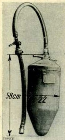
Abb. 1 (links) Innenrüttler. Wird in die Betonmasse eingeführt.
