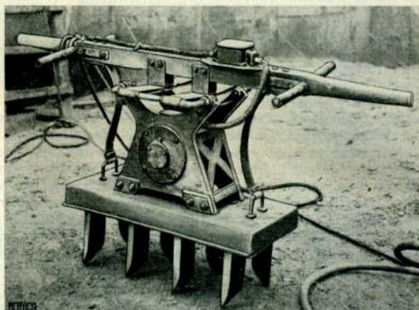
Abb. 3 und 4. Außenrüttler. Wird an der Außenfläche der Schalung des Bauwerkes angebracht.
