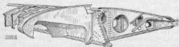
Bild 12. Flügel-Rumpf-Anschlußteil. Die Kastenrippennasen sind zur Aufnahme des Fahrwerks ausgespart.
