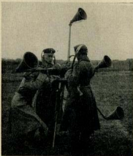
Abb. 3. Hornpostel-Horchgerät, Binauralprinzip. (Weltkrieg.)
