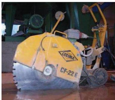
Bild 11.2, Beispiel für einen Diamant-Fugenschneider
